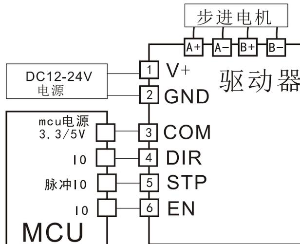
MCU(单片机)只能按共阳极解法，驱动器 COM 接单机电源，则单片机 I/O 口可以直接接到驱动器信号，注意 I/O 输出电流之和不能超过单片机的本身的参数。单片机 I/O 输出也可通过缓冲器接到驱动器，对应 COM 接到缓冲器的电源上。
